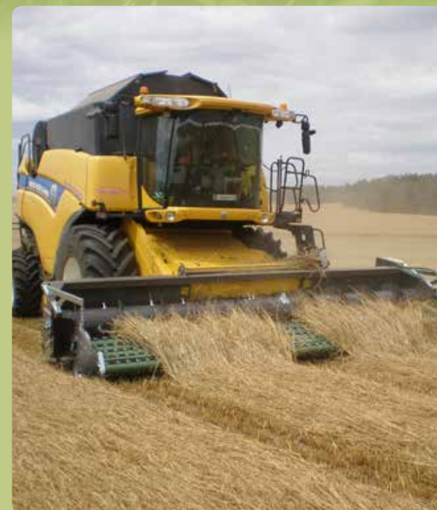
Dvojfázový zber mätonohu jednorodného zberacím kompletom Dekker Tecnomais 5,8 m
