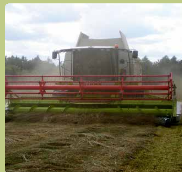
Dvojfázový zber medzirodového hybridu Mahulena zabudovateľným adaptérom Dekker DZ 5,8 m
